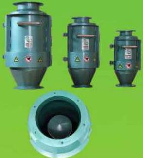
Služe za odvajanje metalnih nečistoća iz zrnastih praškastih proizvoda koji slobodno padaju preko gravitacione cevi. Preporučuje se za mlinove, mešaone stočne hrane skladišta semske robe, ili za razne granulisane ili praškaste materijale. Magnetna kupa je sa Feritnom magnetnom punjenjem tipa Y35 Brmax=4200 Gausa. Čišćenje separatora se vrši ručno. Ovi separatori su standardno sa ulaznim cevima Fi 100, 150, 200, 250, 300, 350. Po zahtevu kupca možemo ih praviti i sa Neodimijumskim punjenjem.
