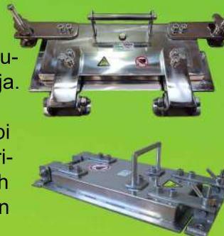
Gornja izvedba se montira iznad transportnih traka, a donja izvedba se montira na kraj transportne trake ili na izlaze iz raznih transporterata kako bi materijal klizeći prolazio preko njih. Ove odvajače izrađujemo u raznim širinama od 100 do 2000 mm zavisno od zahteva kupca. Visina i dubina ovih ploča zavisi od zahtevane privlačene moći magnetne ploče. Magnetno punjenje ovih separatora može biti Feritno Y35 ili Neodimijumsко N52.
