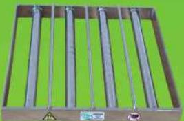
Služe za odvajanje feromagnetičnih jedinica iz zrnastih praškastih materijala. Predviđeni su za ugradnju u gravitacione cevi, usipne koševe ili na izlazne cevi raznih transportera. Prave se sa magnetnim šipkama prečnika Fi 25 ili Fi 34 mm. Punjeni su sa neodimijumskim magnetima tipa N52 sa Brmax=14 800 Gusa. Mogu biti pravougaonog ili kružnog oblika.
