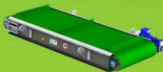
Za separaciju metala iz grudaste, praškaste materijale na transportnoj traci. Preporučeno je za većih komada metala (šraf, ekser, komada žice...) gde su ovi nečistoće u velikoj meri prisutni. Običnu magnetnu ploču trebalo bih veoma često čistiti ručno. Separator odbacuje metalnu nečistoću pored transportne trake. Ploča je punjen sa feritnim magnetima. Debljina ploče zavisi od debljine materijala iz kojeg želimo odvajati metalnu nečistoću.
